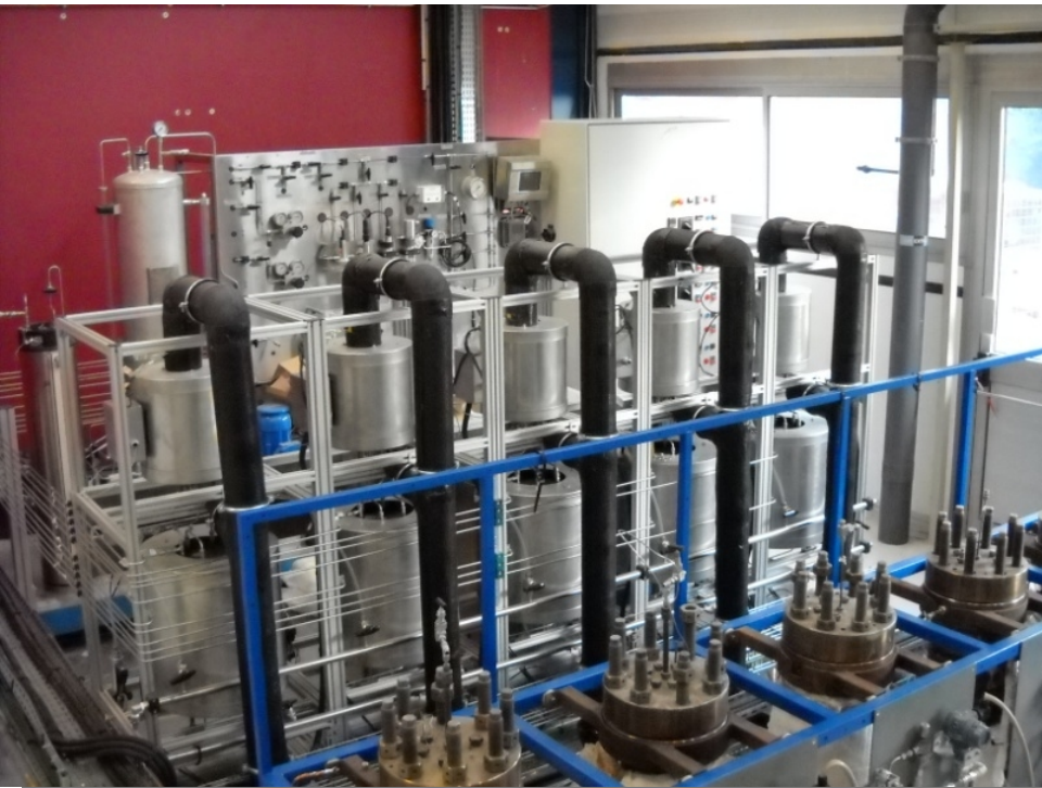
CAMELIA : boucle de corrosion en milieu primaire
