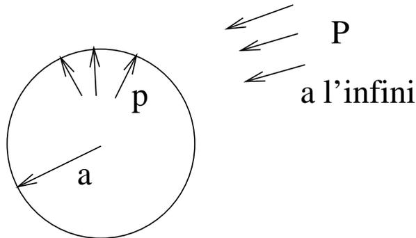
Figure 1 : Géométrie du tunnel et chargement appliqué
