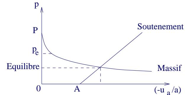
Figure 2 : Courbe convergence-confinement d'un tunnel
