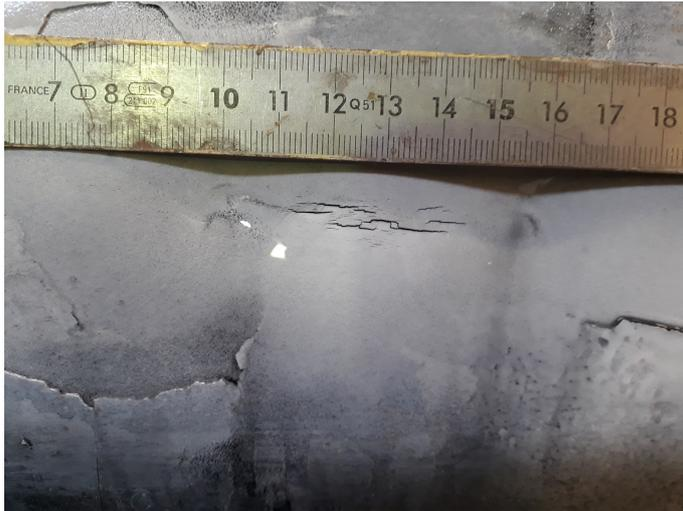
**Figure 1: Exemple de fissuration par fatigue d'une capacité après enfoncement.**
